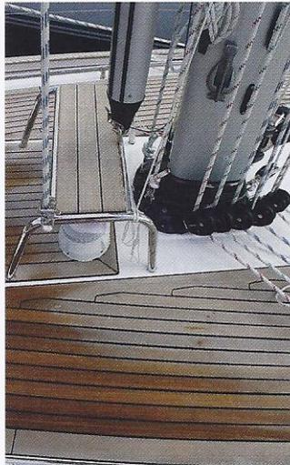
Mehrzweckstufe zum Schutz der Dorade-Lüfter
