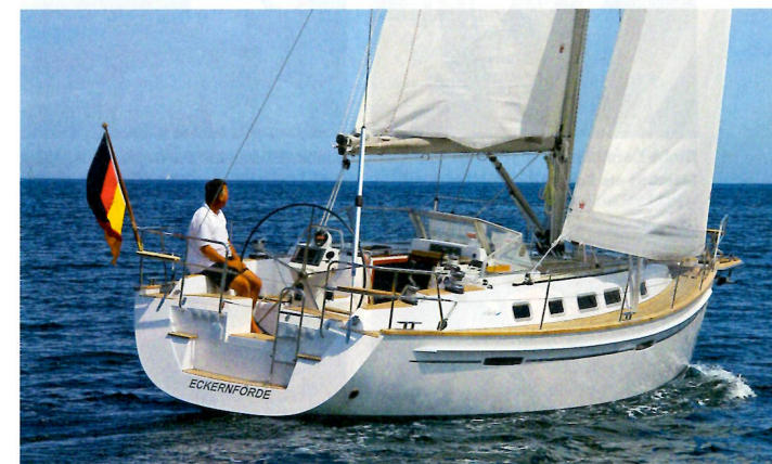
Sinnvolle Teile: ausgeprägte Scheuerleiste, feste Scheibe und eine gute Radgröße
