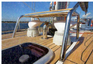
Große Detailliebe: Doradelüfter mit Masttritt als Schutz auf dem Vorschiff
