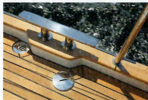
Robuste Lösungen: große Klampen mit Scheuerschutz, Lenzrohr mit Sieb
