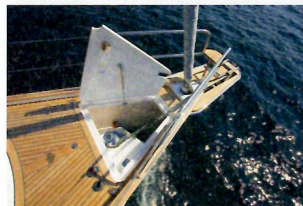
Hilfreiche Option: Tritt mit Blisternase, Leiter und Ankerhalterung in einem
