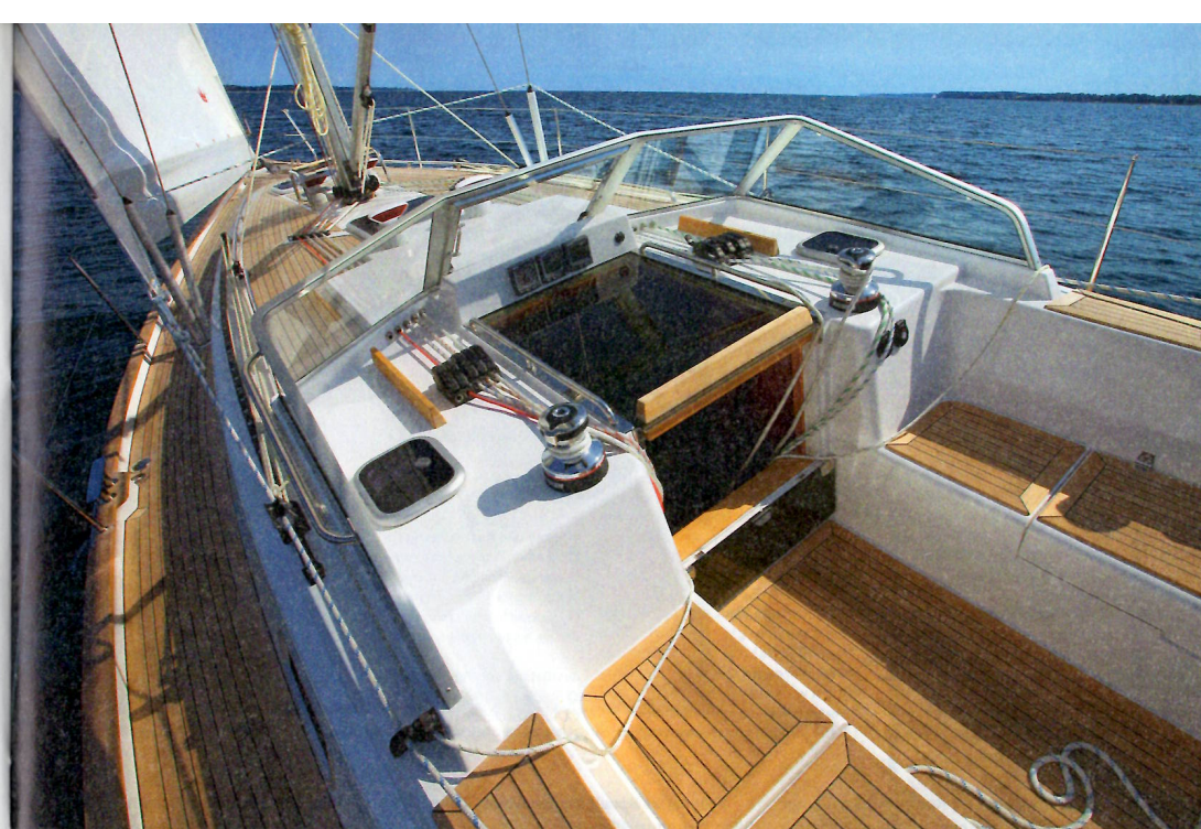
Aufgeräumtes Deck: Innensitzende Wanten erlauben eine große Genua, deren lange Schienen auf dem Kajütdach laufen
